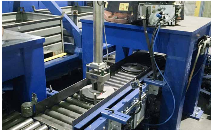
Umgebaute Verpackungszelle mit zwei Robotern, Magnetgreifern und Schwerlastdrehtisch
